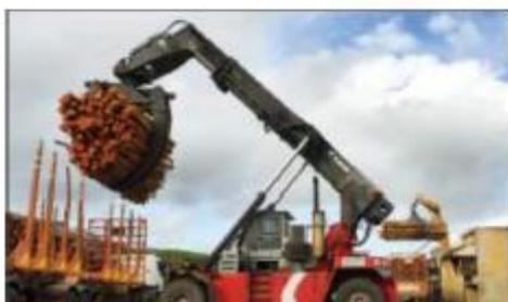
Na fábrica, a máquina carregador *Kalmar 3026* descarrega o caminhão com apenas três movimentos e faz o reempilhamento da madeira.
