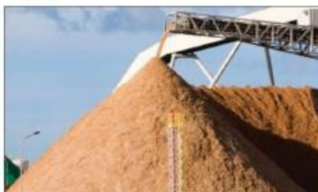
Na sequência, as máquinas denominadas *picadores* cortam a madeira em pequenos pedaços que passam por peneiras para selecionar os cavacos e seguem através de esteira rolante para o digestor, onde serão cozidos.
