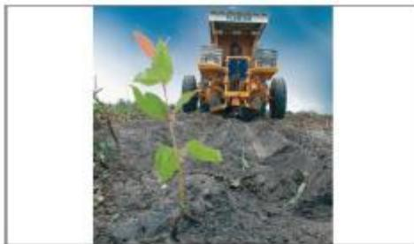
As máquinas plantadeiras são acopladas a tratores, colocam as mudas no solo, fazem a adubação (nitrogênio, fósforo e potássio) e aplicam um gel pré-hidratado nas plantas para reter a umidade das raízes.
