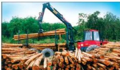
Na sequência, as máquinas *forwarders* empilham as toras de eucalipto na beira da estrada para ser recolhidas pelos caminhões.
