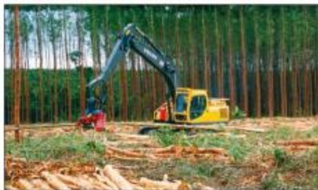
Aproximadamente seis anos depois do plantio, as máquinas *harvesters* cortam, descasam e dividem o tronco do eucalipto em toras de seis metros de comprimento cada.
