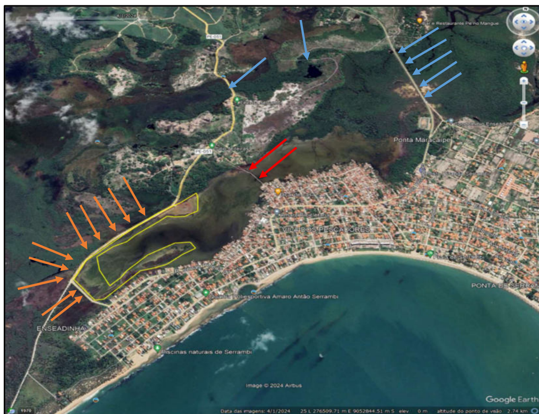
Figura 4.2- As setas apontam para os impedimentos de fluxo hídricos representados por ruas projetadas para atender o Condomínio do Toquinho, pela rodovia PE 051 indicado pelas setas laranjas a esquerda da imagem, pela avenida dos Santos indicado pela seta azul e por passarela construída pela comunidade do entorno indicado pela seta vermelha ao centro da imagem. Em amarelo polígono da área analisada.
