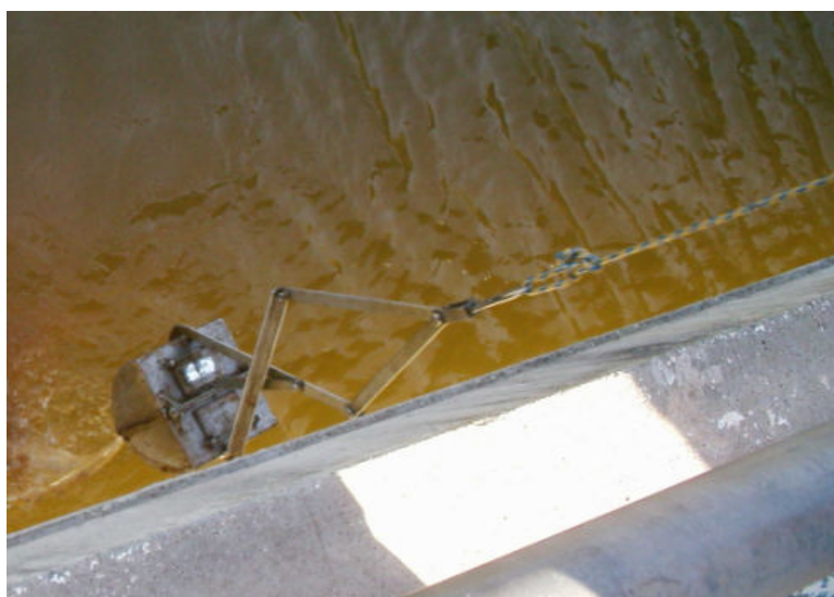
Fotografia 05 – Busca fundo do tipo van Veen utilizado no campo para coleta de sedimentos.
